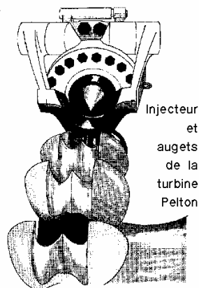
Turbine Pelton avec 6 injecteurs
